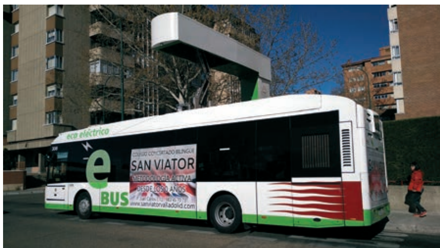
Autobus eléctrico cargando.
