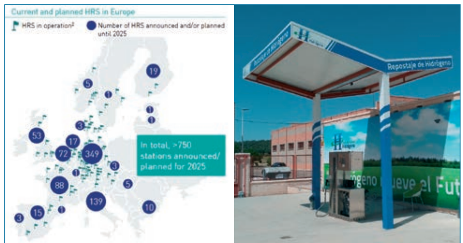
Figura 6. Estaciones de repostaje de hidrógeno. Izquierda: HRS en funcionamiento actualmente y proyectadas para 2025 en Europa [5]. Derecha: HRS del Centro Nacional del Hidrógeno en Puerto Llano, equipada con un compresor instalado por Ariema (fotografía propiedad de Ariema).
