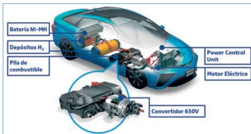
Imagen 8. Distribución componentes del sistema de Pila de Combustible.
