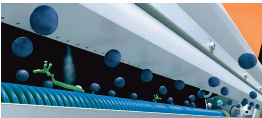
Control de visión artificial para seleccionar las uvas una por una.
