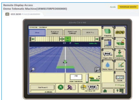
Imagen 3. Visualización remota de la pantalla de control de la máquina.
