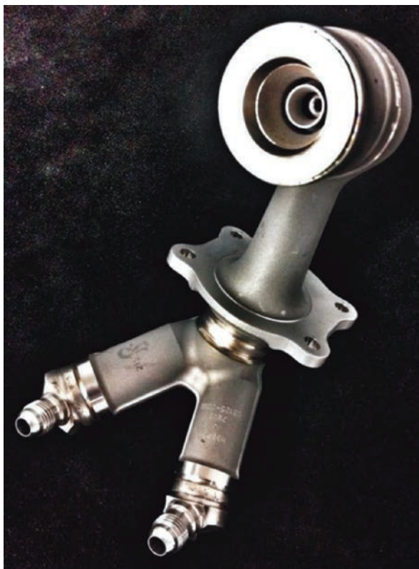
Figura 2. Inyector para turbinas de avión de GE: con una sola pieza de fabricación aditiva se obtiene la misma funcionalidad que con 18 piezas fabricadas por medios tradicionales (Fuente: GE).
