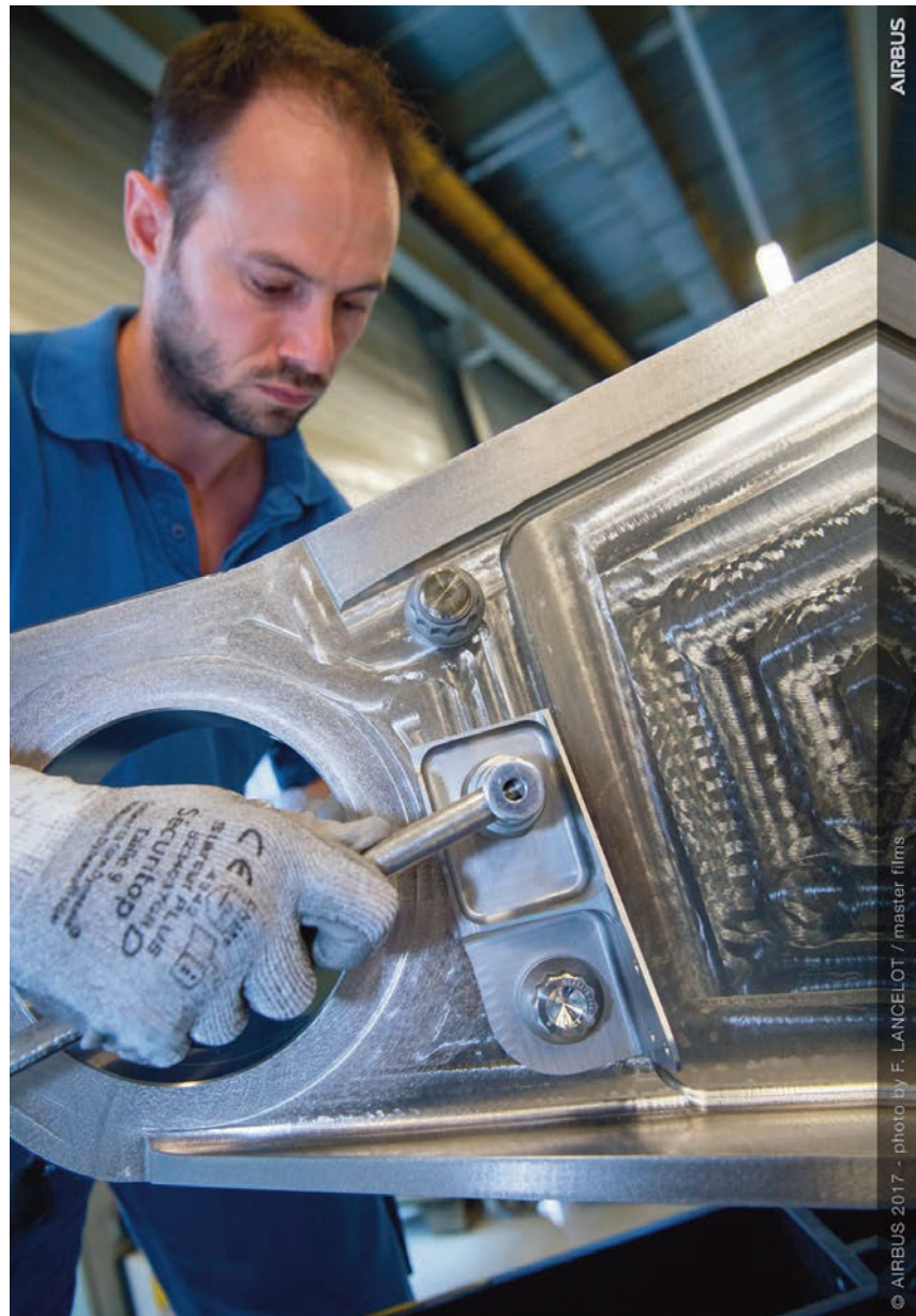
Figura 3. Bracket de Titanio de Airbus, actualmente volando en tests de Airbus A320neo y A350 XWB (Fuente: Airbus).
